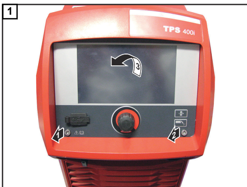
Bedienpanel nach außen klappen
