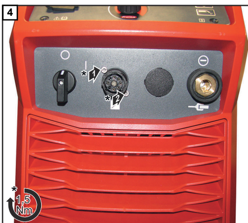
Buchse montieren
