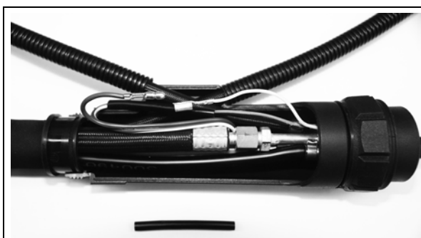
Fig. 16 Démontant un câble de bouton
