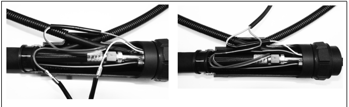
Abb. 17 Tasterleitung mit Durchflusswächterleitung verbinden Schrumpfschlauch zur Isolierung montieren
