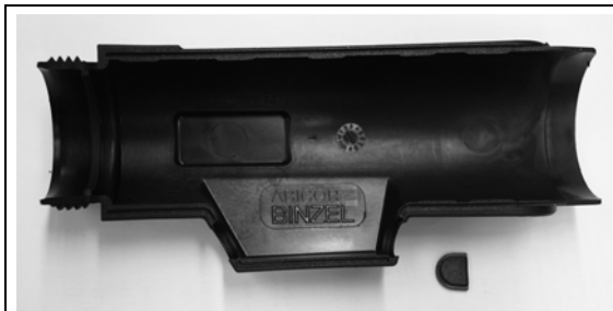
Abb. 18 Verschluss Teil entfernen und Öffnung am Gehäuse für Steuerleitungsausgang nutzen
