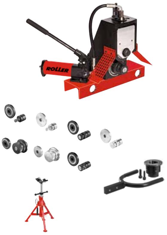
**Kompakte, robuste Rollnutvorrichtung mit ölhydraulischem Druckzylinder für Stahlrohre und andere, DN 25–300, Ø 1–12", Wanddicke bis 7 mm.**
