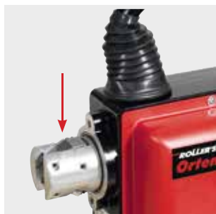
Außerhalb des Gehäuses liegende Spannbacken!
