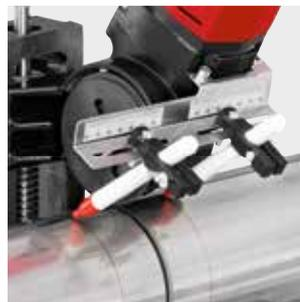
**Kompakte, leichte, robuste Hybrid-Rohrtrennmachine für Akku- und Netzbetrieb. Zum mobilen Trennen und Entgraten von Rohren der Pressfitting-Systeme aus nichtrostendem Stahl, Kupfer, C-Stahl, Ø 8–108 mm, Stahlrohren EN 10255 (DIN 2440) DN 6–100, Ø ½–4", Ø 10–115 mm, Gussrohren (SML) EN 877 (DIN 19522) DN 50–100, Kunststoffrohren SDR 11 Wanddicke  $s \leq 10$  mm, Ø 10–110 mm, Ø ½–4", Verbundrohren Ø 10–110 mm. Akku Li-Ion 21,6 V, 5,0 Ah, für ca. 280 Abschnitte Ø 22 mm mit einer Akkuladung.**
