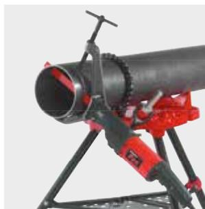
**Kraftvolle, robuste, kompakte Elektro-Rohrsäge ideal für Stahlrohre und andere bis  $\varnothing$  6", 160 mm, sowie für viele Materialien, z. B. Holz, Holz mit Nägeln, Paletten, Metall, auch nichtrostenden Stahl, Guss, Porenbeton, Gipsplatten, Bims, Ziegel, Backstein.**
