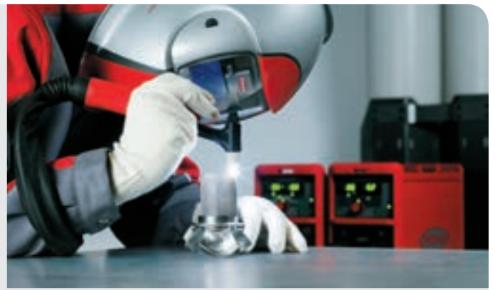
/ Manuelles Mikroplasma-Schweißen für Blechdicken ab 0,1 mm.
