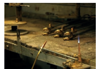
Automatische Gasabschaltung der Gebrauchsflamme
