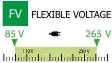
Der Kalibrierkoffer verfügt über die Flexible Voltage (FV)-Technik und funktioniert mit einer Versorgungsspannung von 85 bis 265 V.
