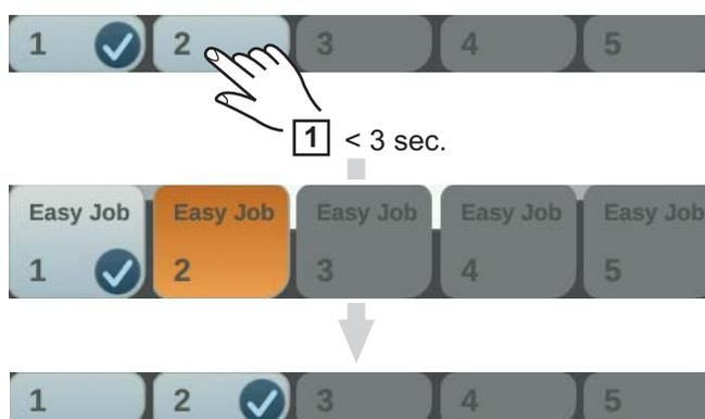
Wird nach dem Berühren einer EasyJob-Schaltfläche kein Häkchen angezeigt, so ist unter dieser Schaltfläche kein Arbeitspunkt gespeichert.
