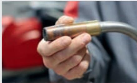
/ Völlig neues Kühlkonzept bis in die Gasdüse des Brenners. Für kühles, präzises Arbeiten und längere Standzeiten der Verschleißteile.
