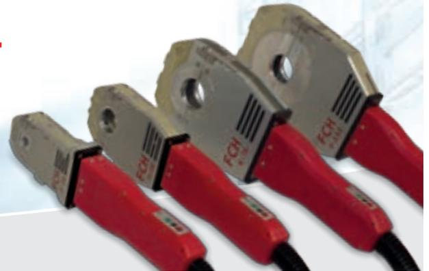
/ Geschlossene Schweißköpfe zum mechanisierten WIG Orbitalschweißen von dünnwandigen Rohrverbindungen (Außendurchmesser 3 - 114 mm, Wandstärken bis 3,5 mm) aus Edelstahl, Titan, Nickel-Basislegierungen, Aluminium und anderen Werkstoffen in der Mikroelektronik, Biochemie, Lebensmittelindustrie, Messtechnik, Luft- und Raumfahrt usw.
