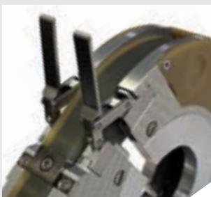
/ federgelagertes Spannsystem
